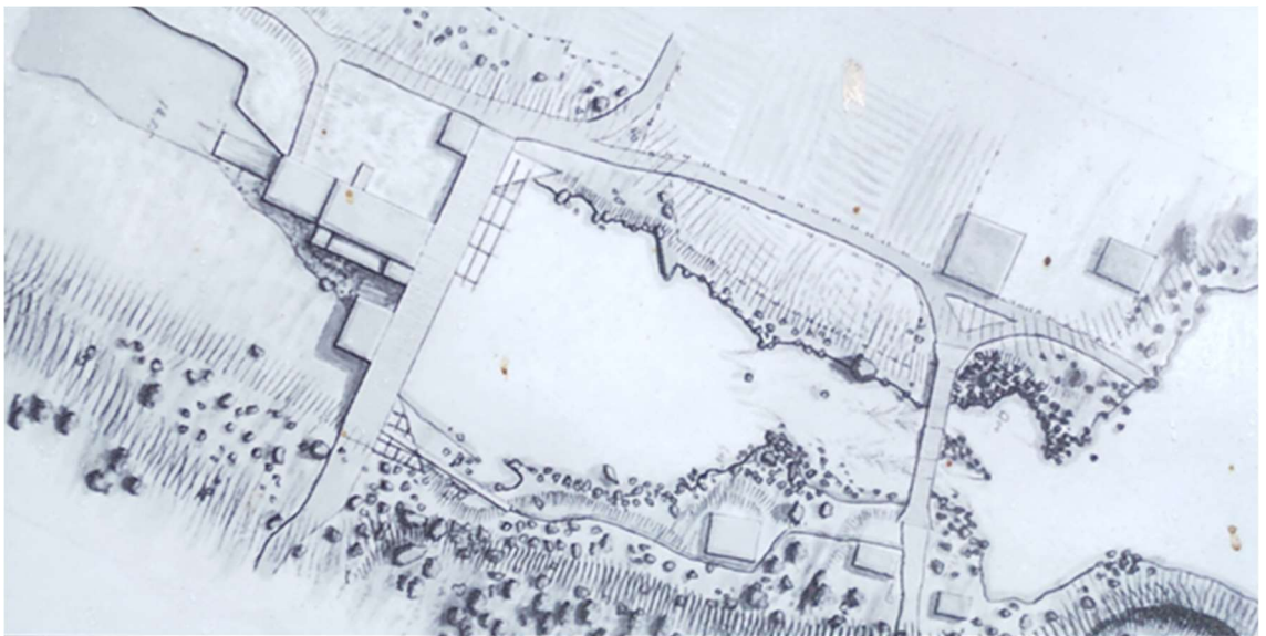
KUVA18: Tie- ja vesirakennushallituksen arkistossa oleva päiväämätön 1800-luvun karttapiirros Enonkosken sahan sijoittumisesta. Luultavasti puukantisena tehty patosilta on sijainnut nykyisen kävelysillan kohdalla. Oikealla silloinen kosken ylittävä tiesilta.
